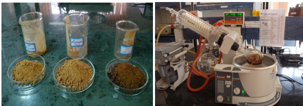
شکل ۳- جداسازی حلال از عصاره‌های تهیه شده از گال Aphelonyx persica و رسوب خشک حاصل
