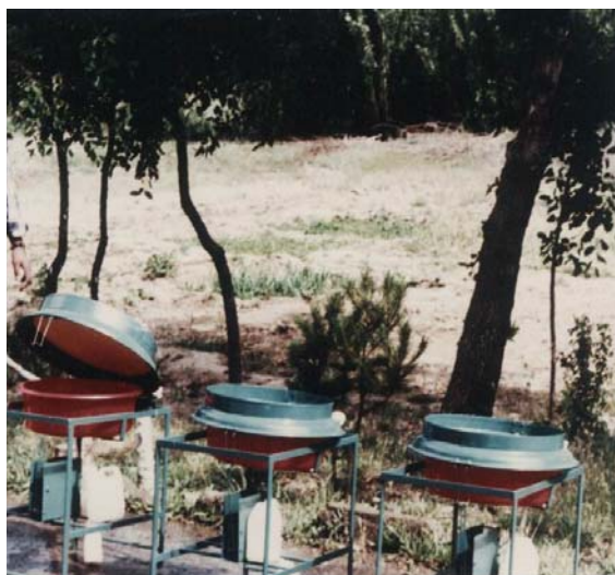
شکل شماره ۱- نحوه نمونه‌گیری باران توسط دستگاه اتوماتیک نمونه‌گیر باران.
