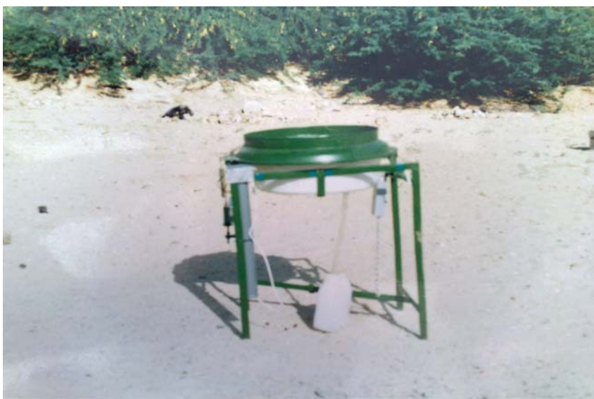
شکل ۳- بارانگیر نصب شده در منطقه طیس کوپان
